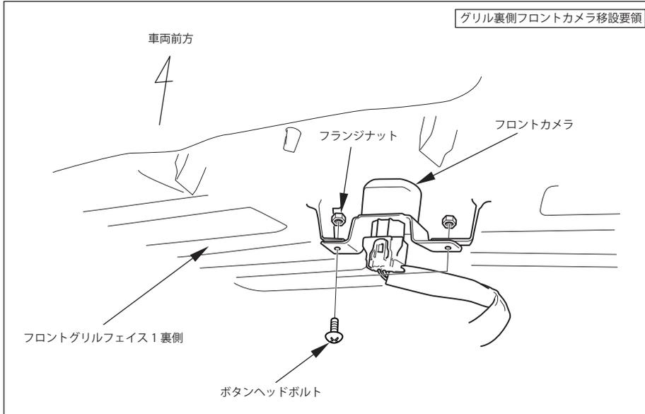
図を参考に、フランジナット、ボタンヘッドボルトを使用し、フロントカメラを移植してください。
