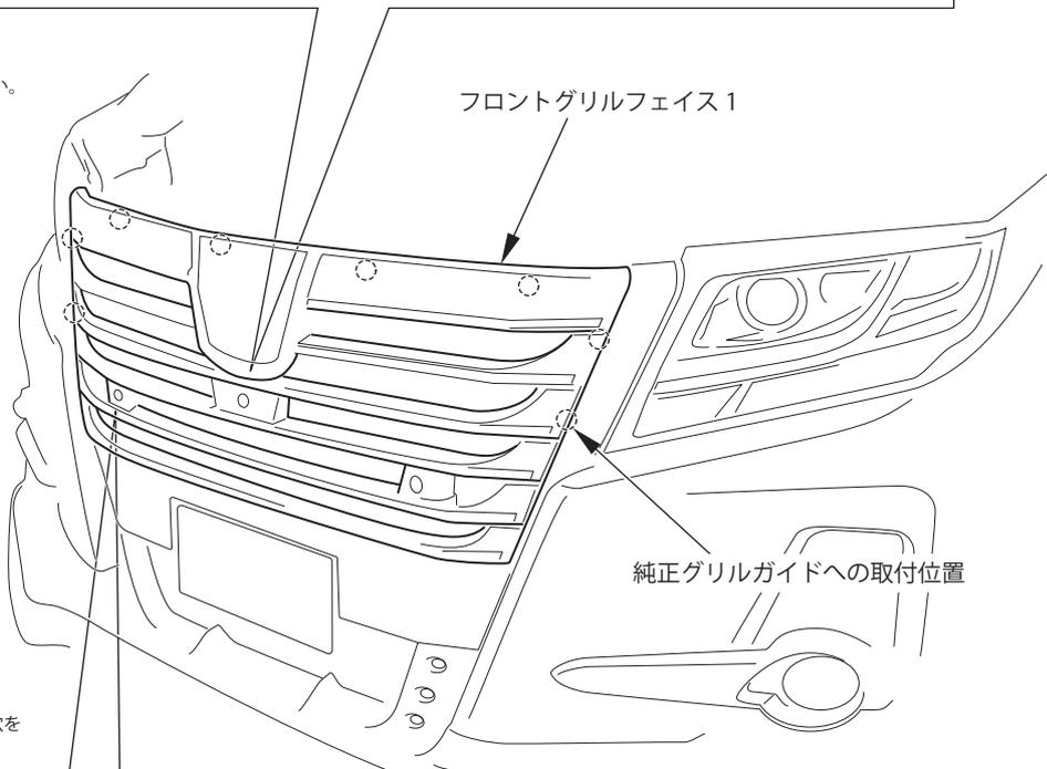
センサーに本体への傷つき、貫きに注意し、2.5mm~3mmの穴を開けてください。
