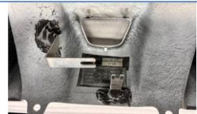
⑤両面テープの剥離紙を少し剥がし外に折り曲げて、製品を車両に仮組みして全体のバランスを調整し、剥離紙を剥がし圧着して下さい。
