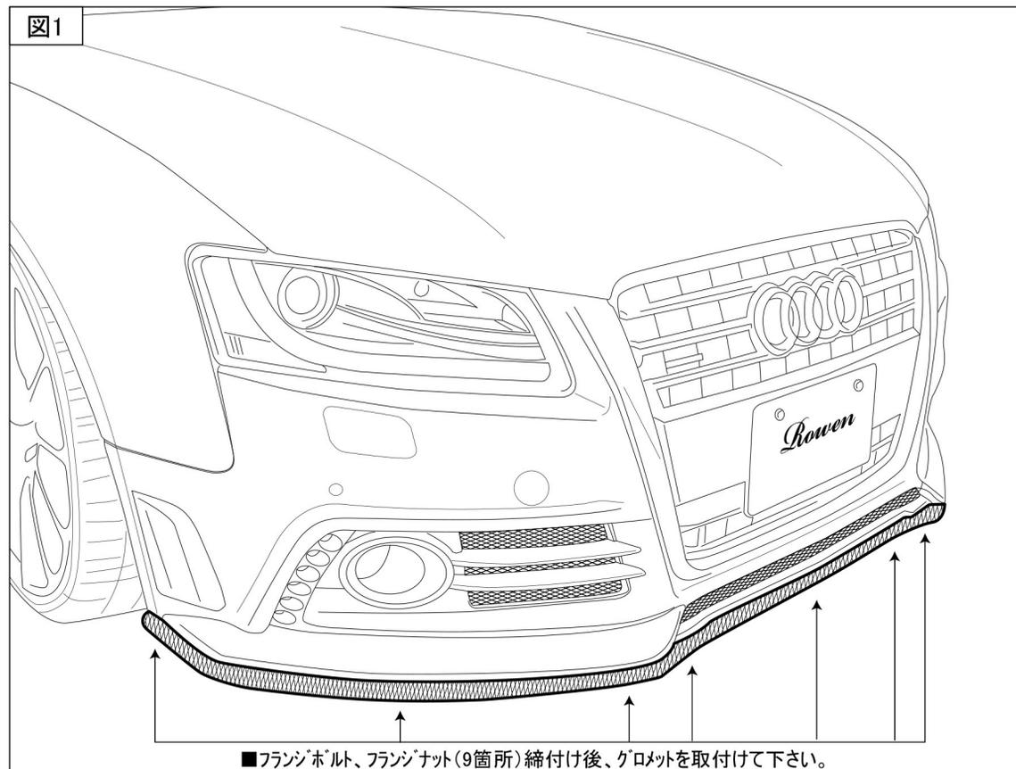
■フランジボルト、フランジナット(9箇所)締付け後、グロメットを取付けて下さい。
